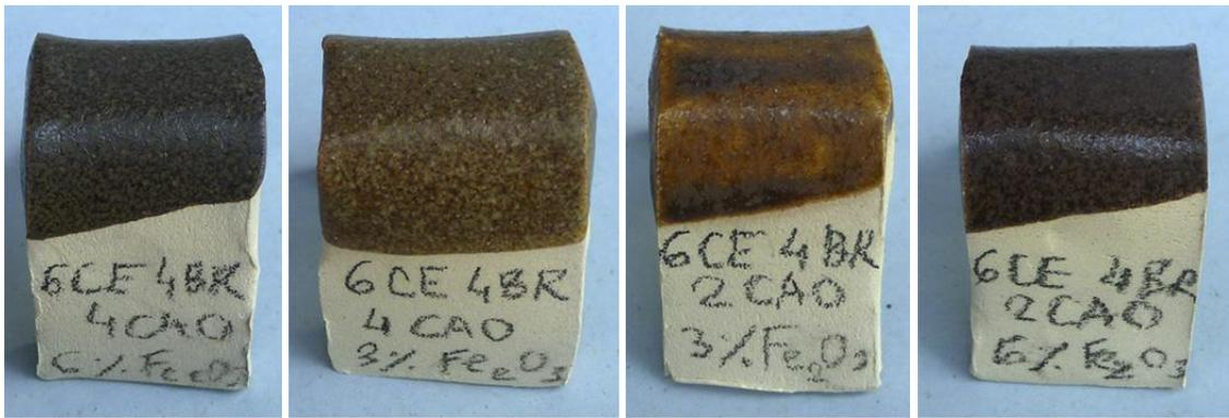
En las pruebas que se muestran a continuación se utilizaron cenizas tamizadas sin lavar y arcilla de Navalacruz.
