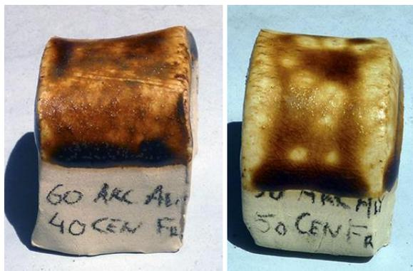
Finalmente, se presentan algunas pruebas en las que se trataba de fundir las cenizas añadiéndoles unas pequeñas cantidades de coleanita o CQ3. Tras comprobar que, a pesar de las adiciones, las cenizas seguían sin fundir, se añadió algo de cuarzo a la mezcla, con lo que se logró la fusión.
